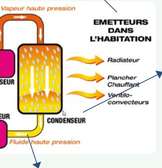
= **Echangeur de chaleur** : Le gaz chaud et sous pression circule ensuite vers le condenseur, où il cède sa chaleur au système de chauffage de la maison (par exemple, un circuit d'eau chaude pour le chauffage central). En cédant sa chaleur, le gaz se condense et redevient liquide.
